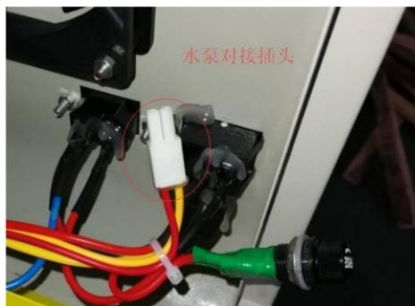
图 2-4：右侧机壳内的“水泵插口”示意图
